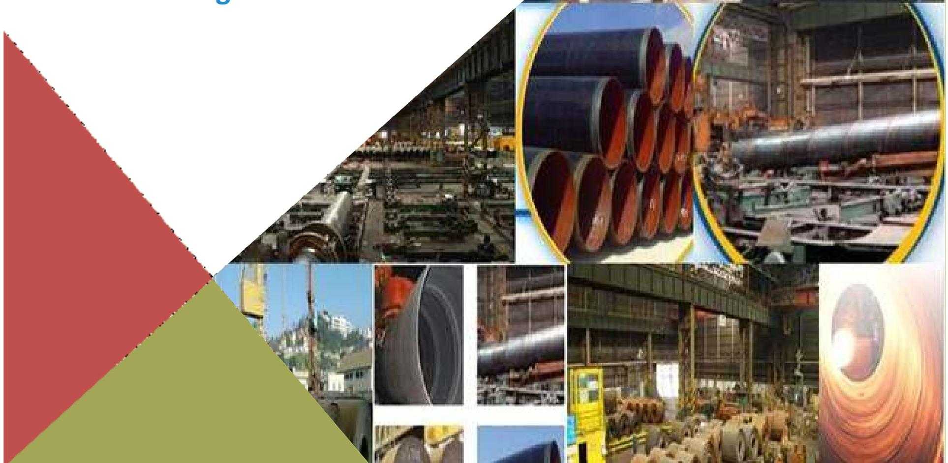
La mission de ALFAPIPE, depuis sa création est la fabrication des tubes soudés en hélicoïdales (SAWH Pipe) à partir de bobines laminées à chaud.
